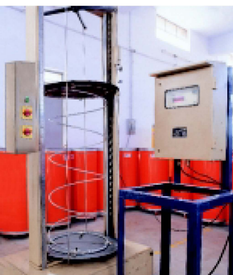
Verificação da tensão da mola
