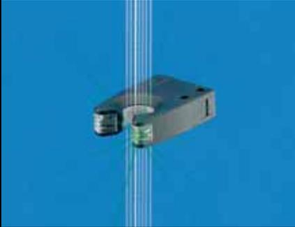
Grazie all'analisi bidimensionale con lente/ceramica ottica, è possibile effettuare il controllo del filato, ponendo lo stesso a contatto con la lente (self-cleaning) o posizionando il filo all'interno dell'ampia area di lettura (8 mm) senza contatto con la stessa (touch-less).
