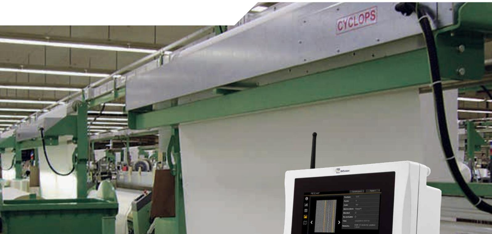
O sistema automático de inspeção de tecidos no tear da BMSvision detecta defeitos de dobra, enchimento e pontos por meio de um sistema de câmera móvel instalado no recolhimento fora do tear.
