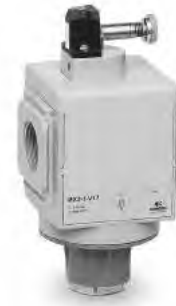
EV53 = Electroválvula, 3/2, monoestável, solenoid pilot com piloto solenoido com fornecimento de ar separado e comando manual biestável
