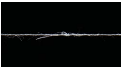
dTex 470: Rotura de filamento
