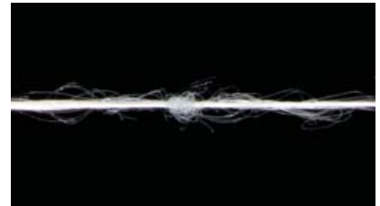
dTex 1100: Rotura de filamento
