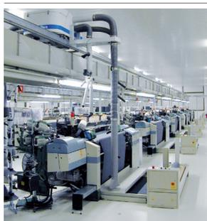
**Limpeza automática para as máquinas de tecelagem**
