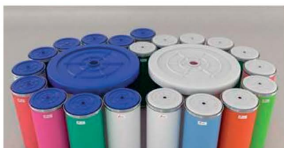
2) Tampa superior com superfície antiderrapante ABS/PP moldada, proporcionando uma base perfeita a aderência a fita sem romper a fibras. Também ajuda alcançar velocidades de nível mais alto da fita. A tampas tem 3 pontos de pretensão a uma distância de 120 graus, melhorando a distribuição da fita dentro da lata.
