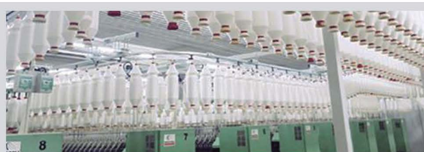
FT60: Bitola 110 mm | bobina de 6"x16" FT70: Bitola 130 mm | bobina de 7"x16"
