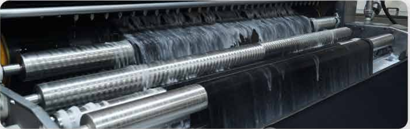
Enzim Yıkama Ünitesi / Enzym Wash Unit
