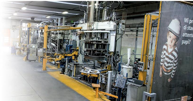
A Rigamonti e Perego fabrica internamente **flanges de alumínio** para os carretéis e sua fundição está equipada com um departamento de rebarbação robótica, garantindo a qualidade dos moldes que são constantemente verificados para garantir aos clientes a mais alta qualidade metalúrgica e a melhor eficiência.
