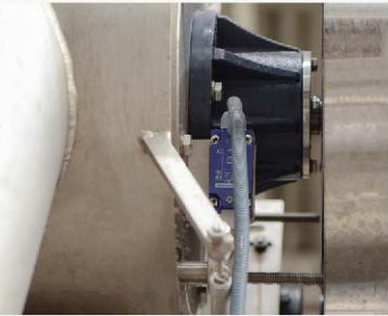
Kule Yataklaması ve Kumaş Takılma Sivici Reel Bedding And Fabric Tangling Switch
